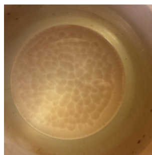
8. ábra. Melegedő kakaóban kialakuló áramlást ábrázoló fénykép, melyhez hasonló bárki saját maga is készíthet.
